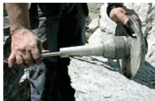
14 La cartuccia starter viene nuovamente rimossa con l'ausilio dell'apposito eiettore.
