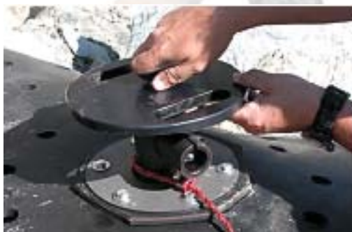
9 Sul meccanismo di innesco viene avvitata una piastra di carico.
