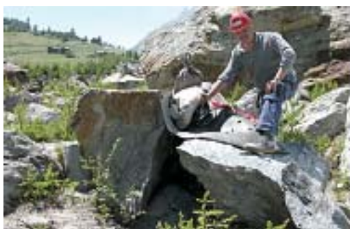
13 Il risultato: il blocco è stato frantumato correttamente in più pezzi con Rock Cracker.
