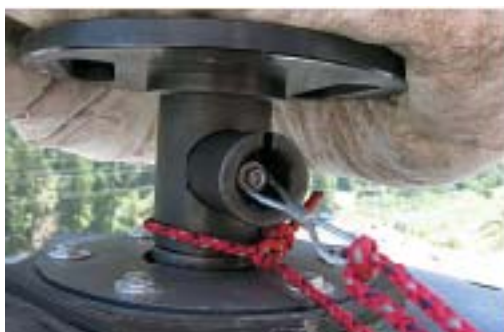
11 La fune viene inserita su Rock Cracker con entrambi gli occhielli.
