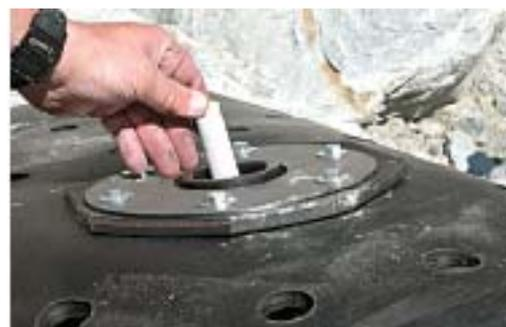
**6** Le tapis de sécurité est placé en position correcte et la cartouche Starter est introduite dans la culasse.
