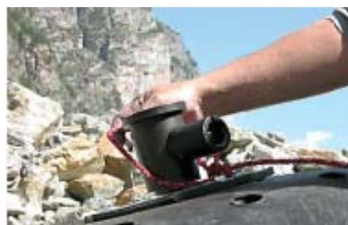
**8** La boucle du cordon de mise à feu est fixée sur le dispositif de mise à feu.
