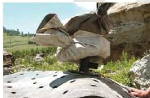
10 Le Rock Cracker est recouvert de sacs de sable.
