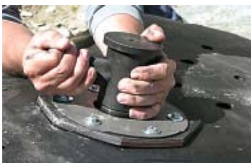
**7** Le dispositif de mise à feu est vissé et serré sur la culasse.
