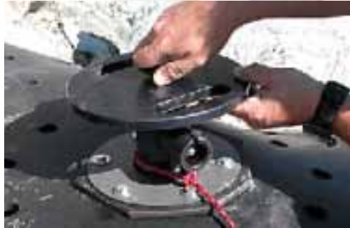
9 Eine Belastungsplatte wird auf den Feuerungsmechanismus geschraubt.
