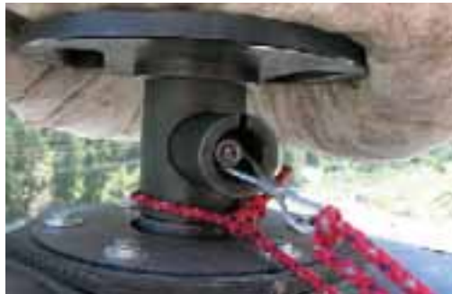
11 Das Verbindungsstück wird mit beiden Kugeln an den Rock Cracker eingehängt.
